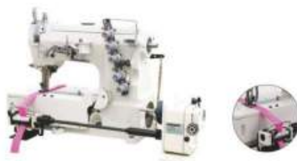
同步送带装置(下送型) Synchronous tape feeder(Down feed)
